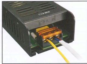
(图6) 输入端接市电安装方式
